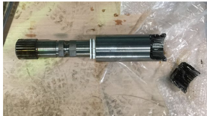
スプライン軸損傷事例
